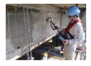
図-2 電位測定状況(回転式照合電極)
