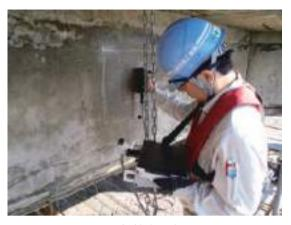
図-3 抵抗率測定状況 表-2 抵抗率と腐食性の判定
