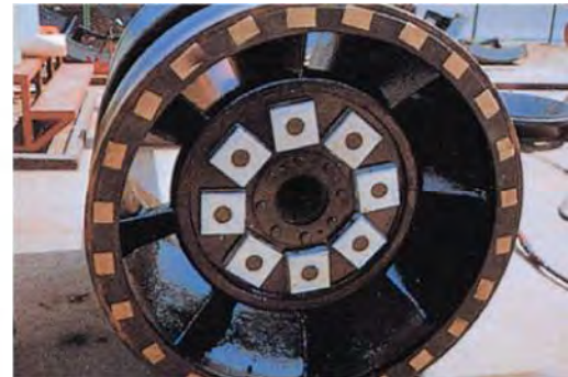
揚水ポンプに対するジンノード（亜鉛陽極）の取付状況
