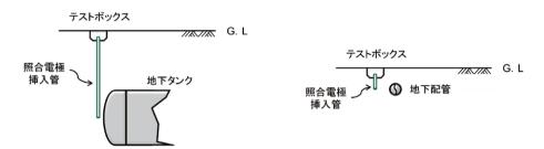
注:照合電極挿人管の設置深度は防食対象施設の中心近傍とする。 電位計測時に照合電極挿入管内に照合電極を入れて計測する。
