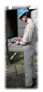
測定は土壌杖のケーブルをオーム・メーターに接続し、メインスイッチを入れ、測定ボタンを押すだけで抵抗率がデジタル数値にて表示される。
